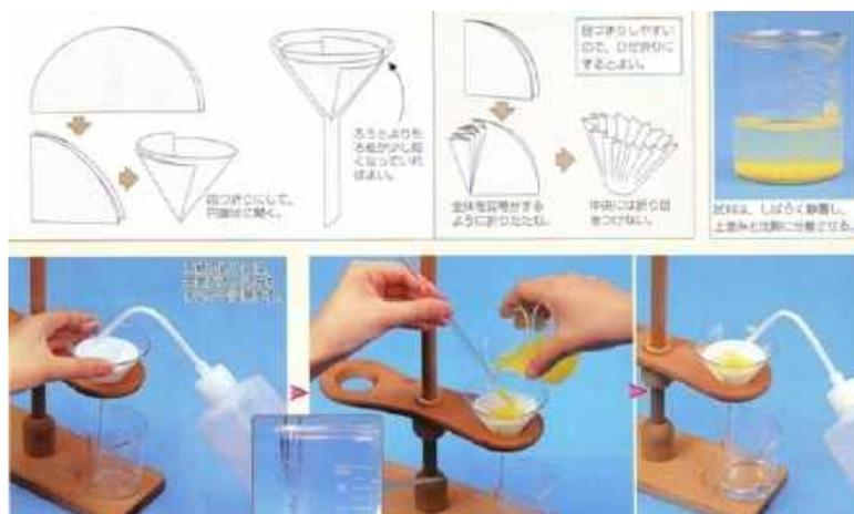
Gambar 1.26. Teknik filtrasi
